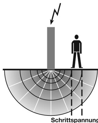
Eine Person nimmt mit den Beinen eine „Schritt“-Spannung auf – ein Teil des Blitzstroms fließt durch den Körper. Dies ist im Umkreis von einigen 10 m rund um den Eintritt in den Erdboden gefährlich!
